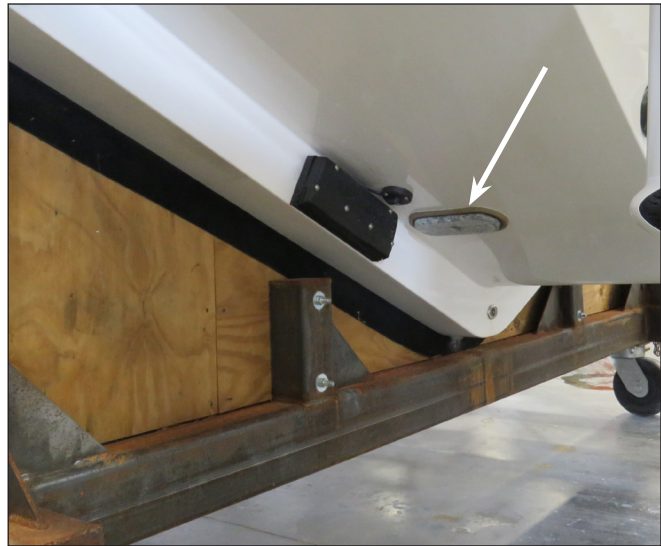
Transom Sacrificial Anode
