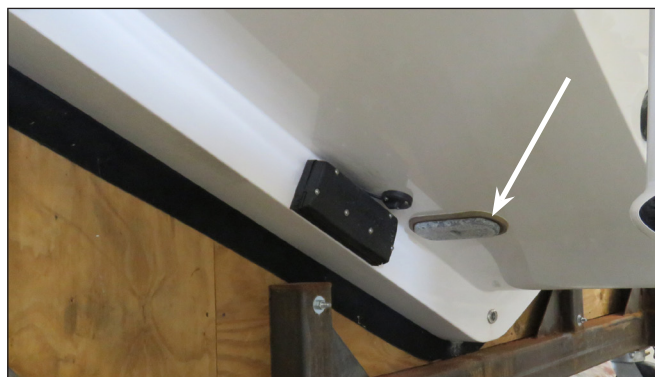
Transom Sacrificial Anode
