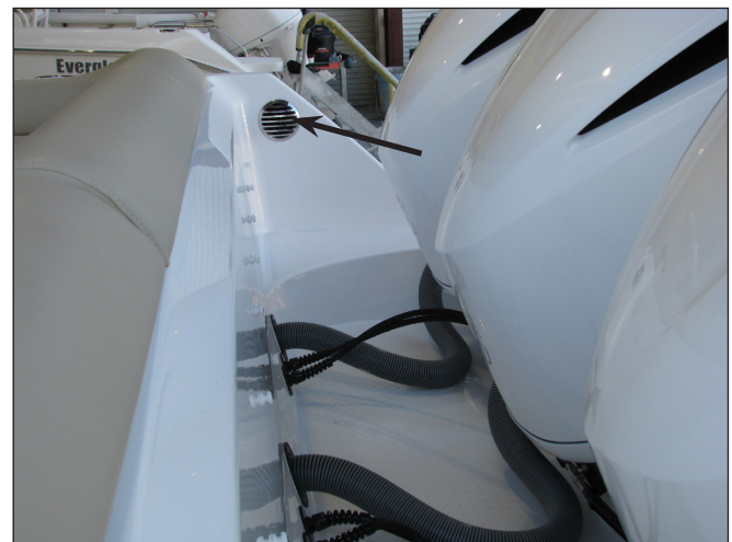
Starboard Bilge Vent
