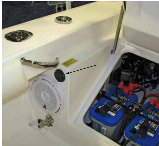
120 Volt Shore Power Inlet Connection
