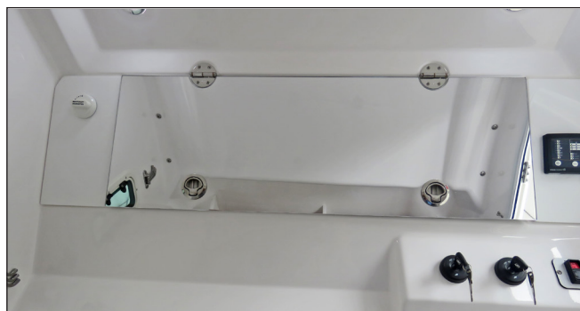
Upper Helm Access Door
